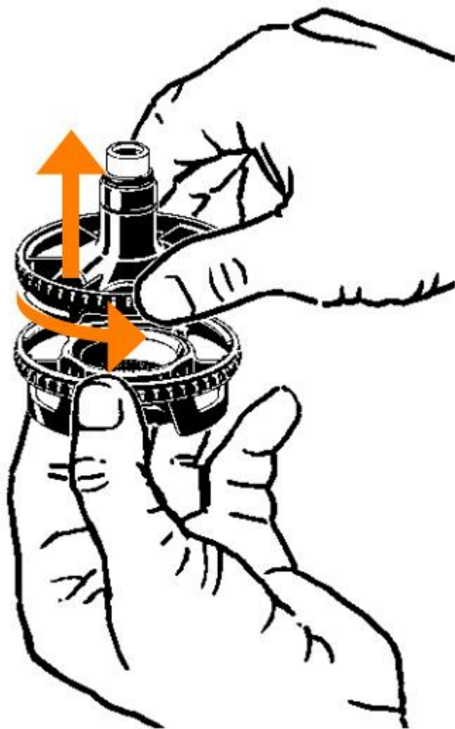
Снятие крышки камеры
