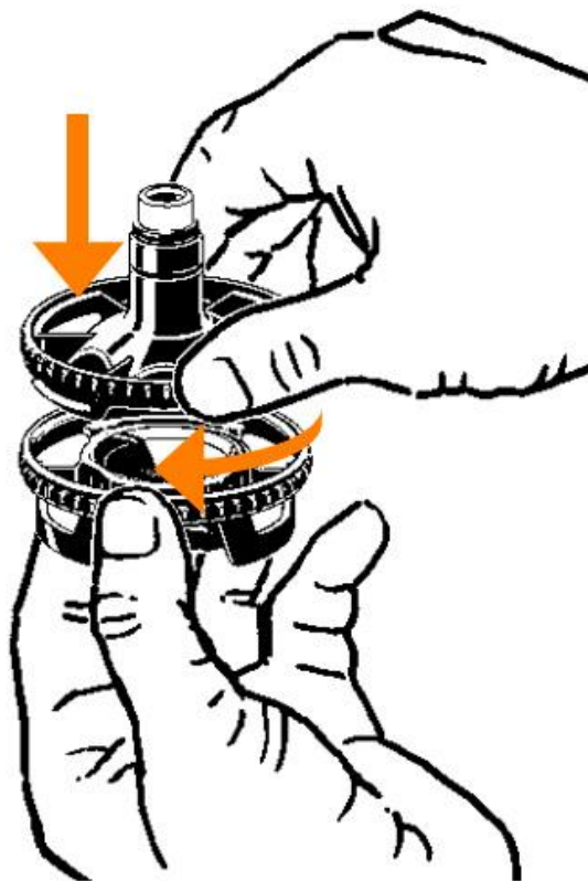
Установка крышки камеры
